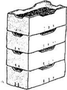
Una caja con tabique- no necesita un colado en el fondo, pues el exceso de humedad se tiene que drenarse durante las lluvias. También necesitan tapa.
